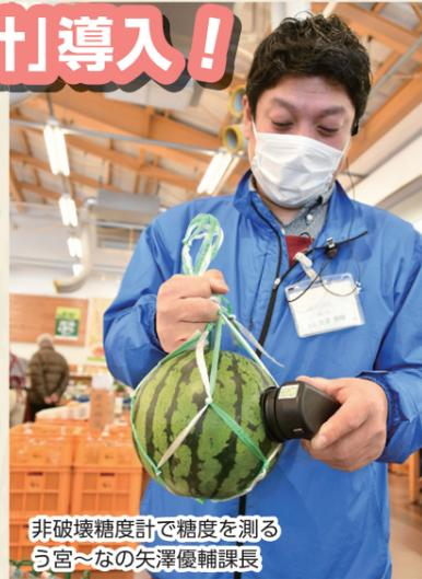
非破壊糖度計で糖度を測る
