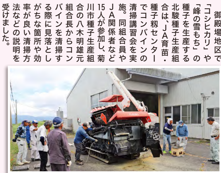
エアークンプレッサーを使い、コンバインの内部まで丁寧に清掃する参加者(中央)
